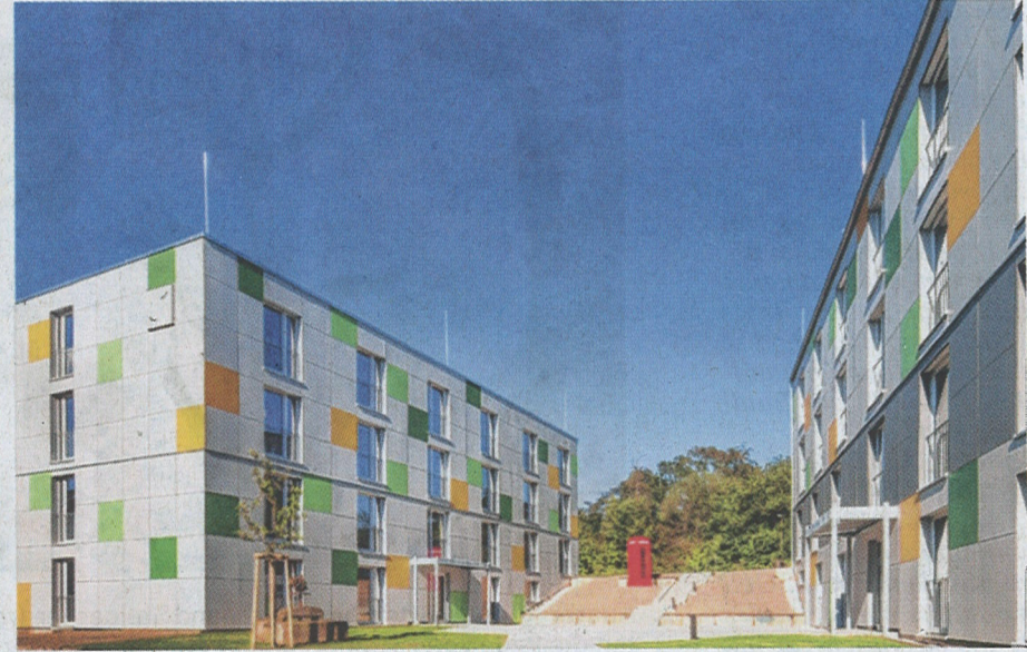
Studentenwohnheim in Trier als Modell für Flüchtlingsunterkünfte, geplant von Grassinger Emrich Architekten. Vorgefertigte Holzelemente werden vor Ort in einer Zeltwerkstatt zu Modulen montiert und mit dem Baukran aufeinander gesetzt.
